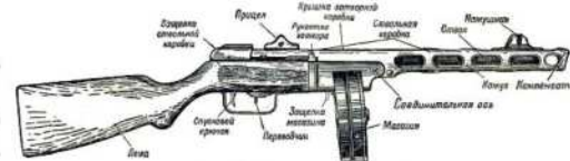
Рис. 1. Общий вид автомата «Бр» 1941 г. (с дисковым магазином)
